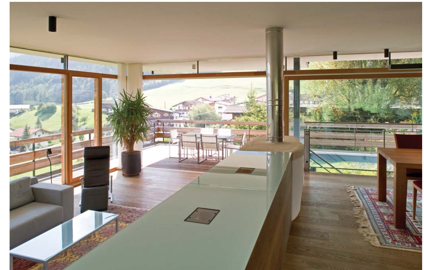
Obr. 1 Bohatě prosklení obytných místností může působit velmi efektně, ale musí být navrhováno s mírou. Skleněné plochy totiž způsobují velké tepelné ztráty v zimě a zároveň přehřívání interiéru v létě. Samozřejmě by měl být promyšlený systém stínění, který je u větších ploch finančně nákladný.
