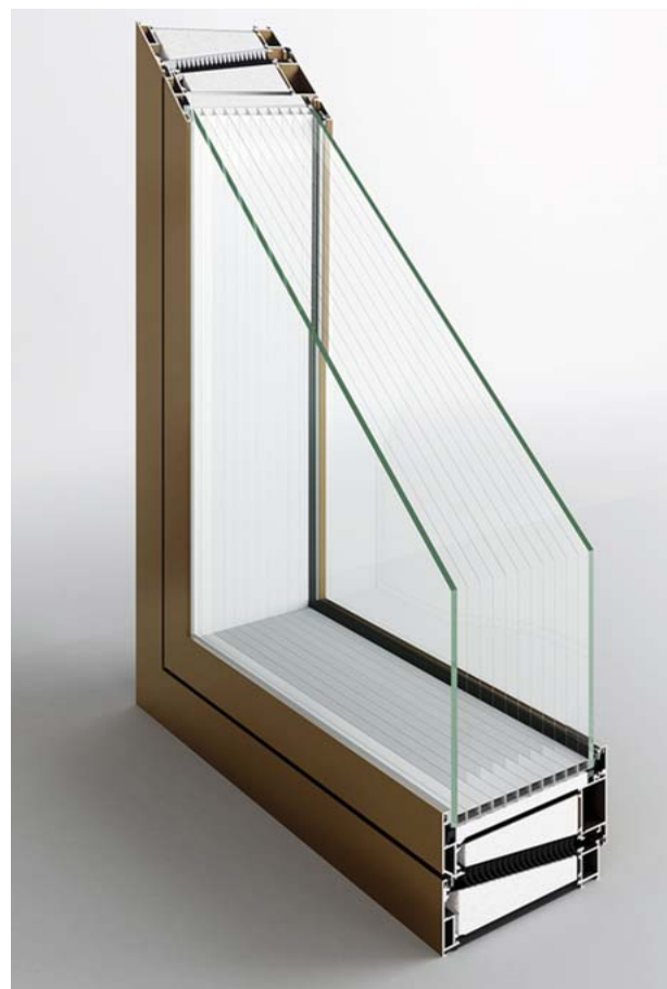
Obr. 10 Revoluci v zasklení může způsobit systém multifólií, který dosahuje izolačních vlastností stěn, a přitom má vysokou propustnost sluneční energie. (Zdroj Superwindows)
